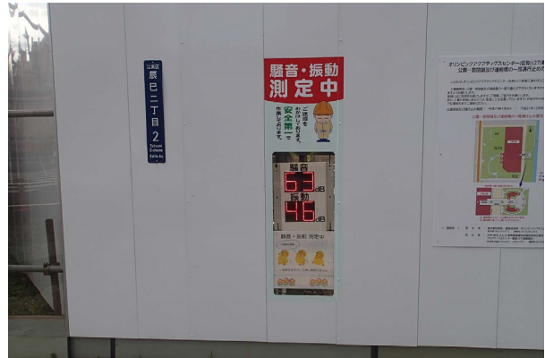
写真 8.5-10 敷地境界での騒音・振動測定
