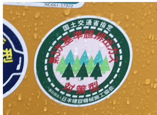
写真 8.1-14 排出ガス対策型建設機械 (第3次基準値)
