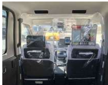
フリート車内に設置したパーティション
