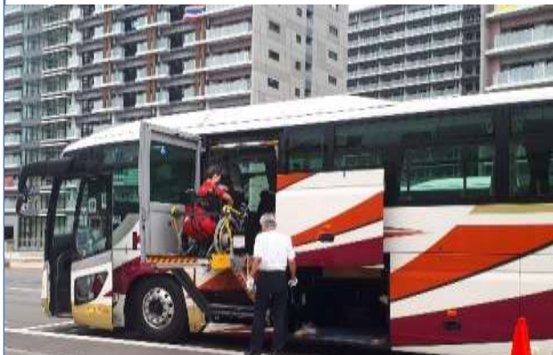
観光バスタイプ（リフト付き） バス付属のリフトで車いすのまま乗降可能
