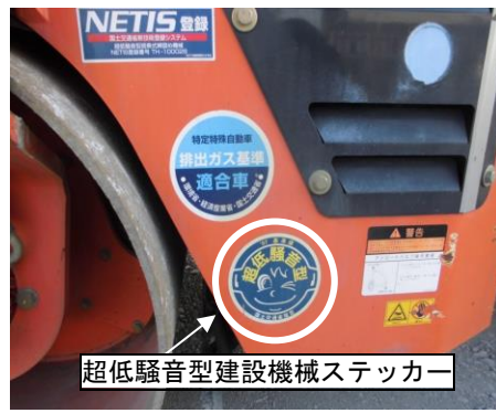
写真 8.2.2-8 超低騒音型建設機械の採用
