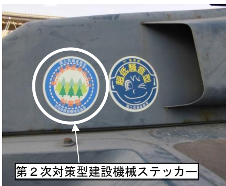
写真 8.2.3-3 排出ガス対策型建設機械の採用
