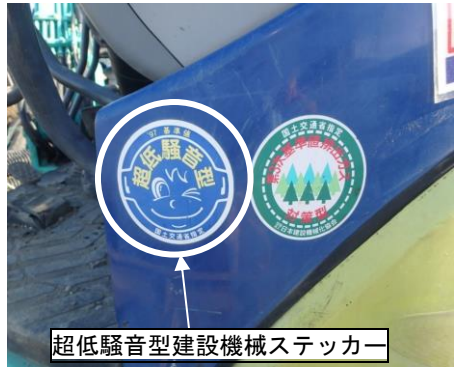
写真 8.2.2-9 超低騒音型建設機械の採用
