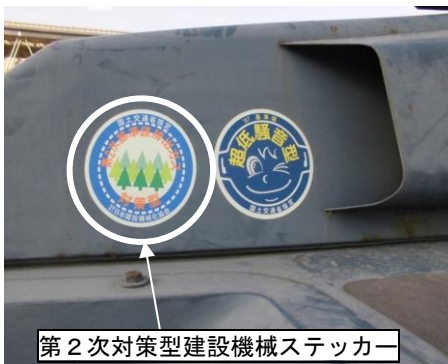
写真 8.2.1-9 排出ガス対策型建設機械の採用
