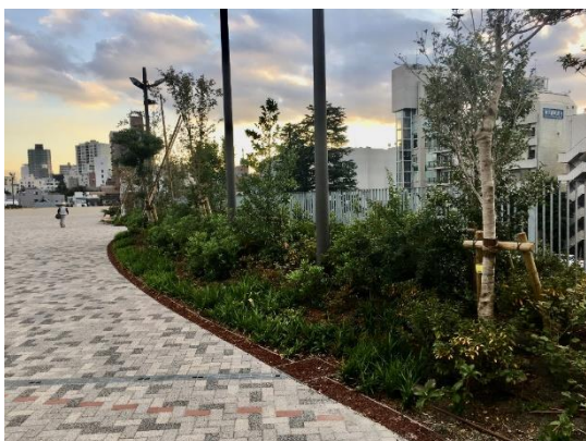
写真 8.3-11 人工地盤上緑化 （計画地南西側）
