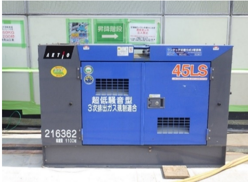
写真 8.1-17 第3次対策型建設機械
