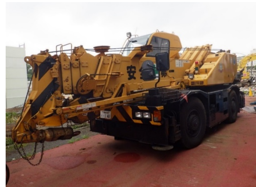
写真 8.5-4 低騒音型建設機械
