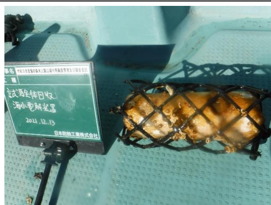
海水電解装置試験片回収後
