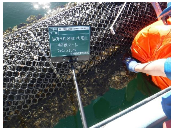
無対策 試験片回収状況
